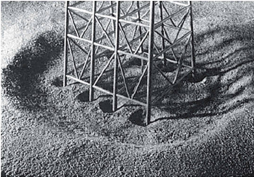
Figure 11.1 : Affouillement généralisé et affouillement local autour d'une plate-forme sur pieux de type jacket (d'après Angus and Moore, 1982)
